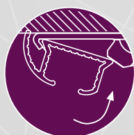
Eenvoudig te monteren: inklikken-positioneren-vastzetten
